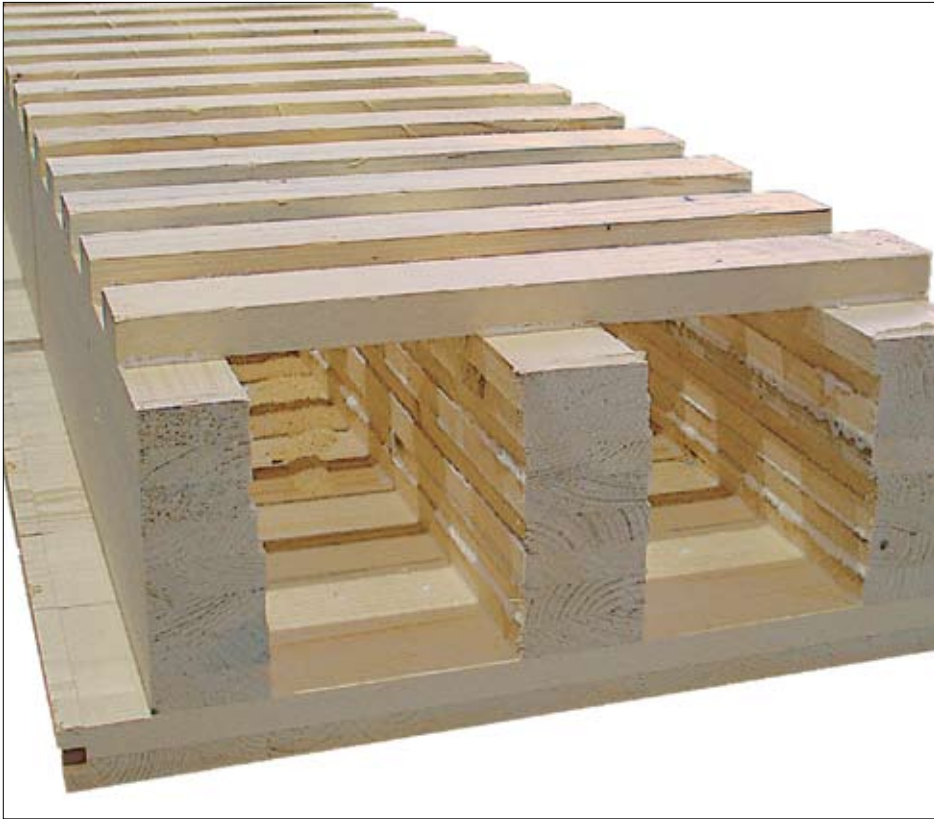
Brettspertholz-Deckenelement mit endgefertigter Untersicht. Die Hohlräume nehmen Installationen und eine schalldämmende Schüttung auf. Oberseitig folgt der Fußbodenaufbau.
