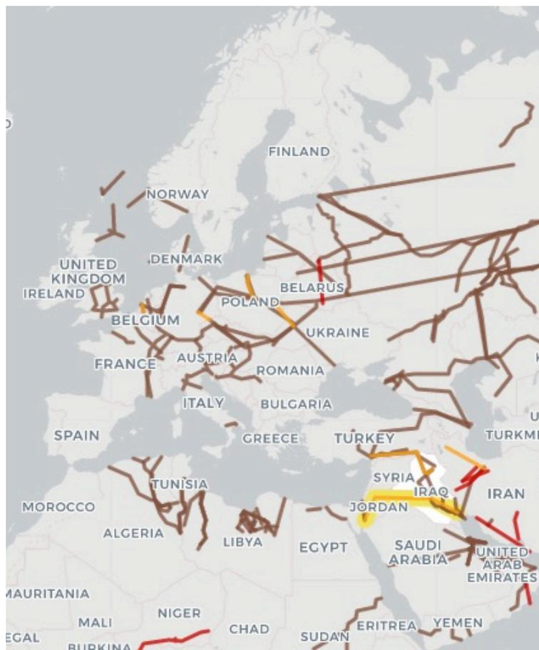
**Abb. 5-7 Bestehende und geplante Rohölpipelines; Farblegende (Farblegende: braun = in Betrieb; rot = im Bau, gelb = geplant)**
