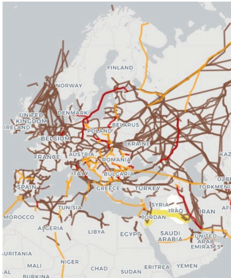
**Abb. 5-8 Bestehende und geplante Erdgaspipelines in Europa und der MENA-Region (Farblegende: braun = in Betrieb; rot = im Bau, gelb = geplant)**
