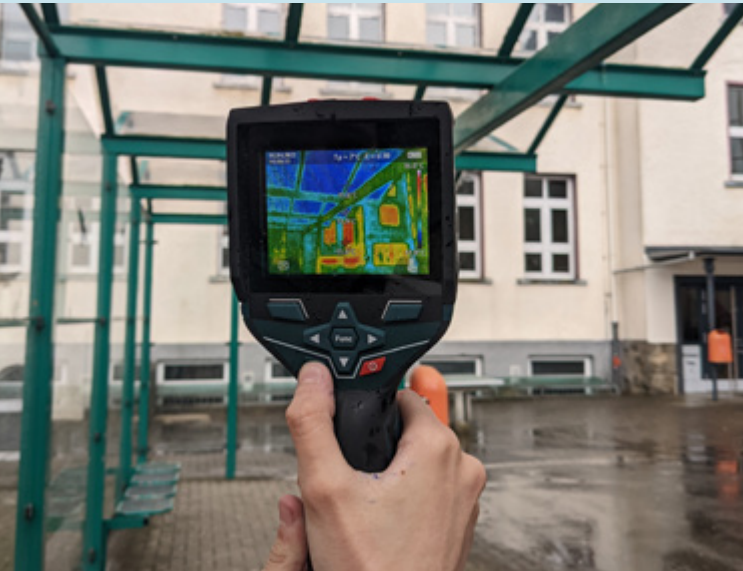
Eine Schülerin nutzt eine Wärmebildkamera zur Ermittlung von Wärmebrücken
